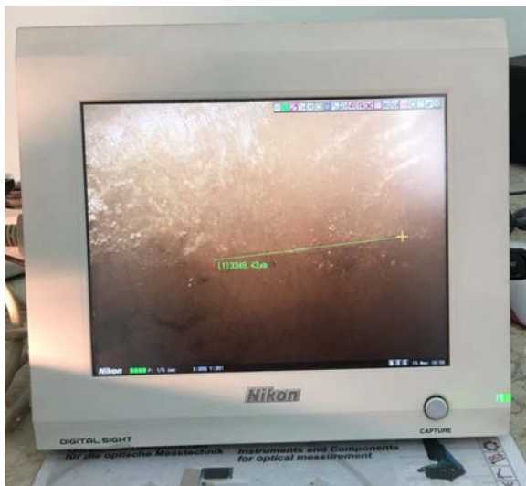
Рисунок 4. Определение длины трещины с помощью оптического стереомикроскопа и цифровой камеры.
