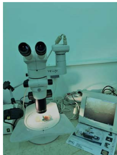
Рисунок 1. Стереомикроскоп, подключенный к цифровой камере.
